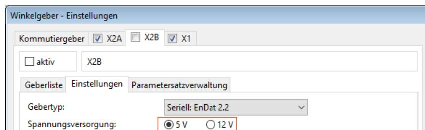
Abbildung 21: Winkelgeber-Einstellungen: Parametrierung der Versorgungsspannung
