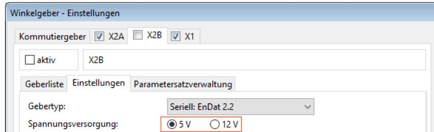
Abbildung 27: Winkelgeber-Einstellungen: Parametrierung der Versorgungsspannung
